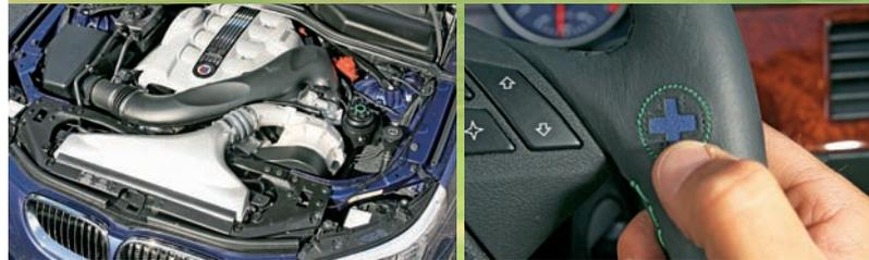
entscheidend ist für die Effizienz eines Motors. Bei der Drehzahl des maximalen Drehmoments (700 Newtonmeter bei 4250/min) sind das beim B5-Triebwerk eindrucksvolle 20 bar, der M5-V10 (520 Nm bei 6100/min) kommt gerade mal auf 13,1 bar.
