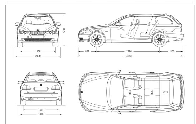
Alle Maßangaben der technischen Zeichnungen in Millimeter. Gepäckraumvolumen 500 bis 1.650 I (VDA-Messung).
