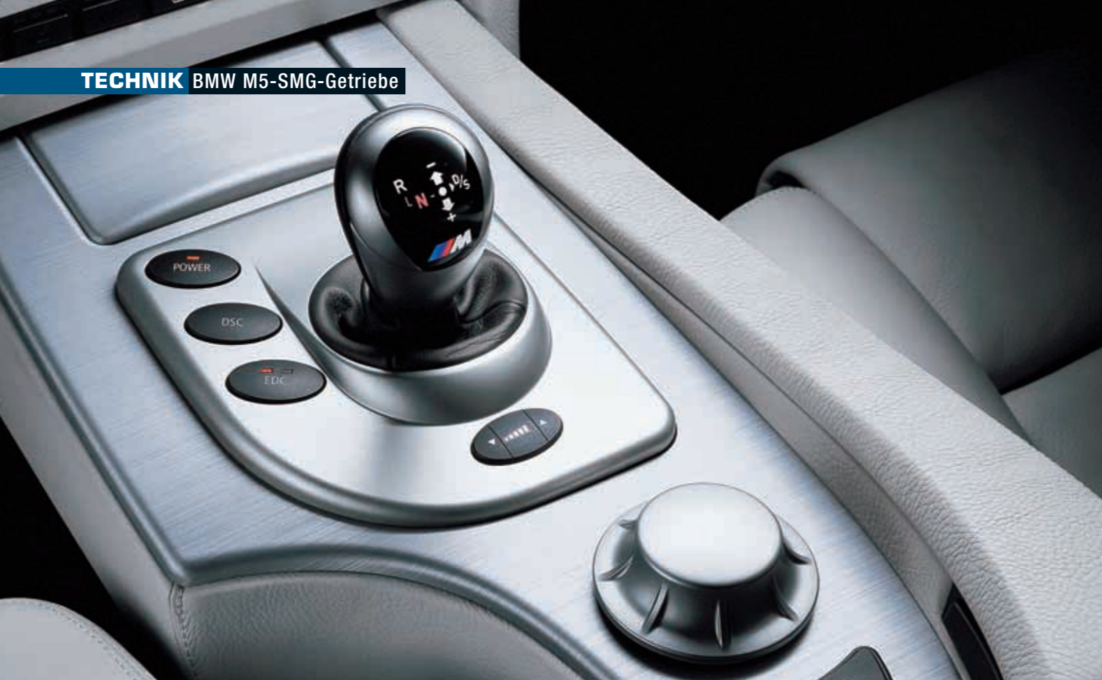
KURZE SCHALTZEITEN Gegenüber dem Sechsgang-SMG des BMW M3 arbeitet das Siebengang-SMG des M5 ohne Schaltverzögerung und ist damit fast zehnfach schneller als ein geübter Fahrer, der manuell schaltet
