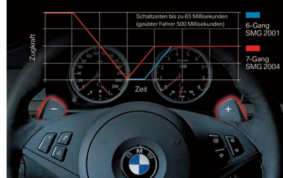
KURZE SCHALTZEITEN Gegenüber dem Sechsgang-SMG des BMW M3 arbeitet das Siebengang-SMG des M5 ohne Schaltverzögerung und ist damit fast zehnfach schneller als ein geübter Fahrer, der manuell schaltet
