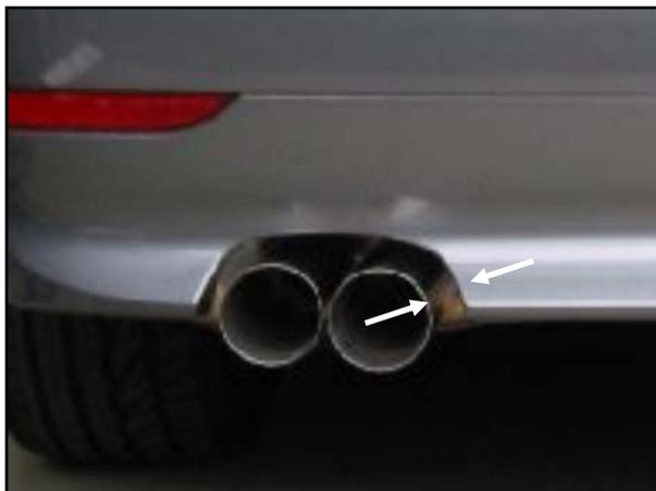
3. Nach Ausarbeitung des Ausschnittes, den **eisenmann®** - Endschalldämpfer in den Haltern einhängen und exakt im Ausschnitt ausrichten. Die Klemmschelle anziehen und unbedingt darauf achten, dass dabei die Lage der Schalldämpferanlage nicht verändert wird. Durch leichtes Rütteln der Anlage prüfen, ob diese spannungsfrei hängt.
