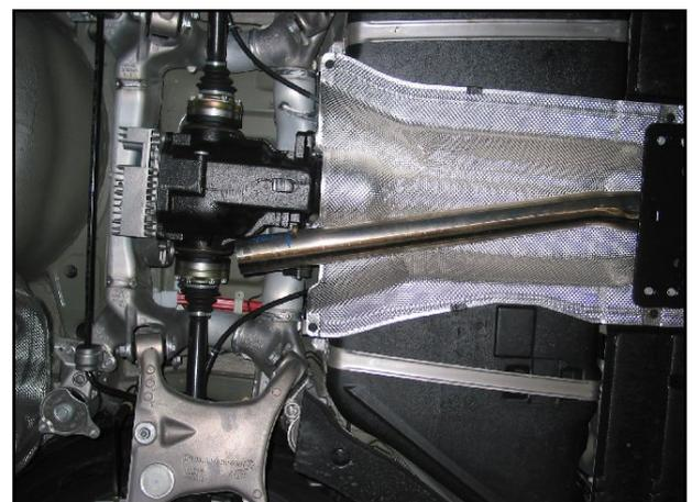
4. Bei Diesel – Fahrzeugen den originalen Schwingungstilger abschrauben und am **eisenmann®** - Endschalldämpfer verschrauben.
