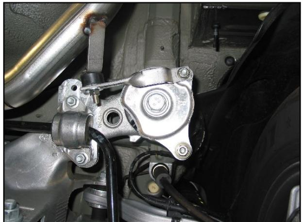
7. Den Halter mittels des Vibrationsdämpfergummis mit dem Auslegerendrohr verschrauben. Das Endrohrstück auf den Auslegerarm aufstecken und Klemmschelle leicht anziehen. Die Auslegerendrohre achsensymmetrisch zu den Endrohren des Endschalldämpfers positionieren. Die Abstände der Endrohre zur Heckschürze sowie der Abstand zur Stossleiste müssen identisch sein. Den Halter fixieren und Bohrung anzeichnen.
