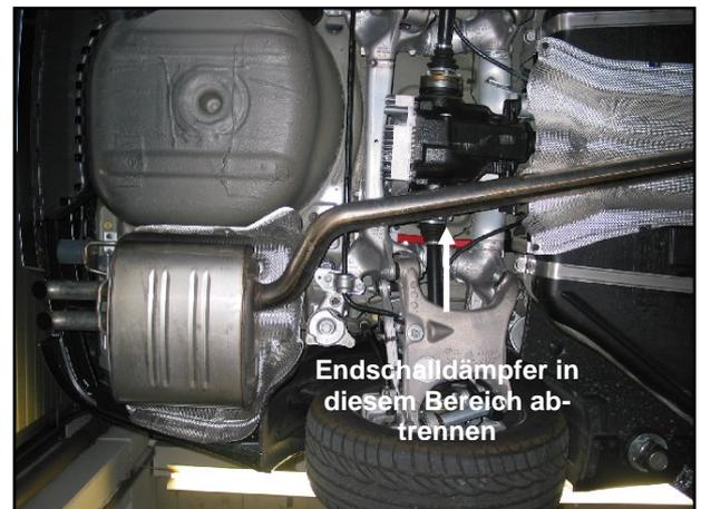
3. Den Original – Endschalldämpfer ausbauen. Falls Schrauben und Muttern schwer zu lösen sind, diese mit Rostlöser einsprühen. Beim Auswechseln des Endschalldämpfers die Originalabgasanlage auf schadhafte Teile überprüfen und gegebenenfalls durch neue ersetzen. Die Trennstelle mit Feile oder ähnlichem entgraten.
