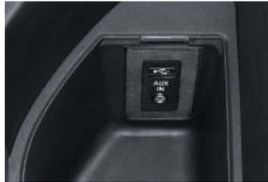
□ **USB-Audio-Schnittstelle** ermöglicht den Anschluss von Apple iPods, MP3-Playern und USB-Speichersticks zum Abhören gespeicherter Audiodateien. Bedienung und Wiedergabe über Controller, Favoritentasten und Lenkradtasten sowie die jeweilige Audioanlage.
