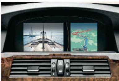
□ **TV-Funktion** ermöglicht Ihnen, das Control Display bei stehendem Fahrzeug als Fernseher zu nutzen. Es können terrestrisch ausgestrahlte analoge und digitale (DVB-T) Programme empfangen werden.
