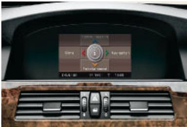
■ **Control Display** (6,5 Zoll, in Farbe) zur Darstellung der Funktionen, die per Controller gesteuert werden (z. B. Bordcomputer oder Radio).
