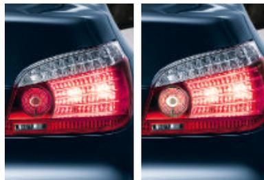
■ **Zweistufige Bremsleuchten** helfen nachfolgenden Fahrzeugen, Ihre Bremssituation besser einschätzen zu können: Im Falle einer Notbremsung vergrößert sich die Leuchtfläche der Bremsleuchten. So kann der nachfolgende Verkehr sofort ein leichtes Abbremsen von einer Vollbremsung unterscheiden – für noch mehr Fahrsicherheit.
