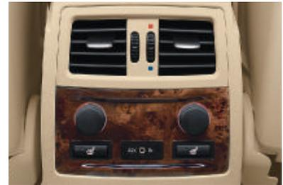
■ **Frischluftausströmer** hinten. In Verbindung mit der Klimaautomatik mit erweitertem Umfang ist die Fondbelüftung temperierbar (hier abgebildet).
