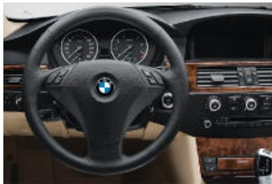
■ **Lederlenkrad**, drei Speichen, mit Multifunktionstasten (Durchmesser 385 mm); über die integrierten Tasten lassen sich Radio, CD-Laufwerk und Telefon (optional) bedienen – die Hände bleiben sicher am Lenkrad. Zwei Tasten sind frei programmierbar.
