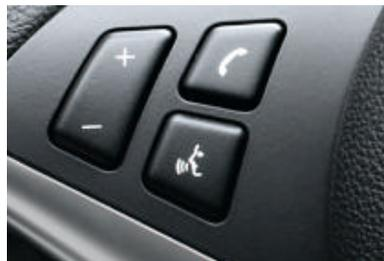
□ **Spracheingabesystem:** Damit lassen sich während der Fahrt z. B. Radiosender, Navigationsziele oder Telefoneinträge steuern, die gleichzeitig im Control Display angezeigt werden (diese Funktion ist in der Ausstattung Navigationssystem Professional enthalten).
