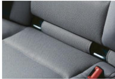
■ **ISOFIX Kindersitzbefestigung für die beiden äußeren Fondsitze** ermöglicht – durch sicher einrastende Steckverbindungen – einen leichten Ein- und Ausbau der als Original BMW Zubehör erhältlichen Kindersitze.
