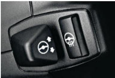
□ **Lenkradheizung** erwärmt auf Knopfdruck innerhalb kurzer Zeit den Lenkradkranz – besonders angenehm im Winter.
