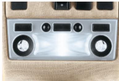
■ **Innenleuchten** mit Innenlichtautomatik, „Soft“-Ein-/Aus-Schaltung beim Öffnen/Schließen des Fahrzeugs, Auflichtbeleuchtung der Mittelkonsole sowie Leseleuchten vorn und hinten.
