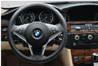
□ **Sport-Lederlenkrad** liegt durch den kleinen Durchmesser (379 mm) sehr gut in den Händen, drei Speichen, mit Multifunktionstasten; über die integrierten Tasten können Sie während der Fahrt Radio, CD-Laufwerk und Telefon (optional) bedienen. Zwei Tasten sind frei programmierbar.
