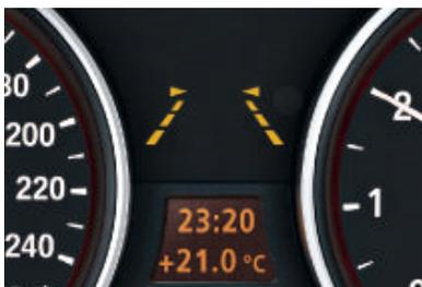
□ **Spurverlassenswarnung** erkennt mithilfe einer Kamera bereits das Annähern an eine Fahrbahnmarkierung und warnt den Fahrer sofort per Vibration am Lenkrad. Das System ist für Bundesstraßen und Autobahnen ausgelegt und wird über eine Taste im Multifunktionslenkrad ein- und ausgeschaltet.
