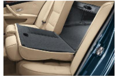
□ **Durchladesystem** mit asymmetrisch teilbarer Rücksitzlehne (im Verhältnis 2 : 1). Der enthaltene **Skisack** ermöglicht den sauberen und sicheren Transport von bis zu vier Paar Skiern bei maximal vier Personen im Fahrzeug; wird der Skisack nicht benötigt, ist er platzsparend in einer austauschbaren Kassette verstaut (inkl. 12-Volt-Steckdose im Gepäckraum).
