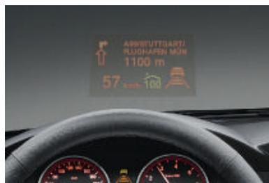
□ **Head-Up Display** liefert dem Fahrer direkt ins Blickfeld fahrrelevante Informationen, beispielsweise über die aktuelle Geschwindigkeit. Darüber hinaus lassen sich Pfeilhinweise der Navigation, Funktionen der Aktiven Geschwindigkeitsregelung mit Stop&Go-Funktion, Funktionen der Spurverlassenswarnung und Check Control darstellen.
