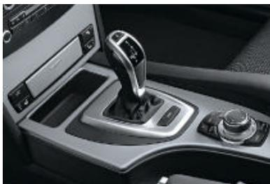
□ **6-Gang Sport-Automatic-Getriebe** verfügt für eine besonders dynamische Fahrweise über eine Sportcharakteristik mit kürzeren Schaltzeiten und ist mit Schaltwippen am Sport-Lederlenkrad ausgestattet (erhältlich für 530i, 550i, 530d und 535d, nicht in Verbindung mit xDrive).
