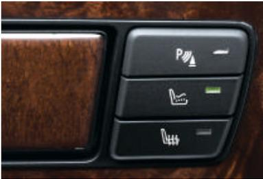
□ **Aktivsitze für Fahrer und Beifahrer** sorgen auch auf längeren Strecken für entspanntes Sitzen und Fahren. Das Becken und die Lendenwirbelsäule werden durch wechselseitiges Heben und Senken der Sitzfläche in zyklischen Abständen mobilisiert.
