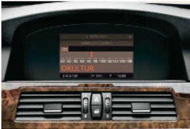
■ **Radio Business**, 4-Kanal-Verstärker, Antennen-Diversity, Scan-Funktion, CD-Laufwerk mit Titel-Scan und motorischem CD-Einzug/-Ausschub, sechs Lautsprecher, MP3-Decoder. □ **Radio Professional**, Umfang wie Radio Business, darüber hinaus u. a. 2-Tuner-Empfang. □ **DAB-Tuner** zum zusätzlichen Empfang digitaler Radioprogramme.
