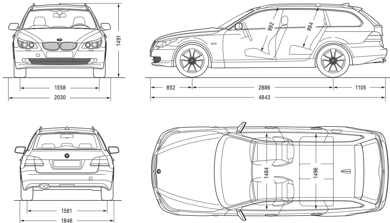
Alle Maßangaben der technischen Zeichnungen in Millimeter. Gepäckraumvolumen 500 bis 1.650 l (VDA-Messung).
