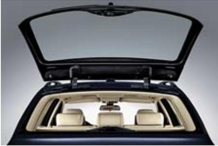
■ **Heckscheibe, separat aufklappbar:** kann zum schnellen und bequemen Ablegen oder Herausnehmen von Gegenständen separat geöffnet werden.
