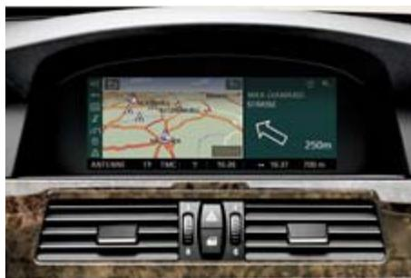
□ **Navigationssystem Professional** mit farbigem 8,8-Zoll-Display, inkl. Radio Professional. Zwei getrennte Laufwerke für CD bzw. Navigations-DVD. Verkehrsführung erfolgt über Sprachhinweise und Pfeildarstellung bzw. 3-D-Routenkarte, Split-Screen-Funktion.
