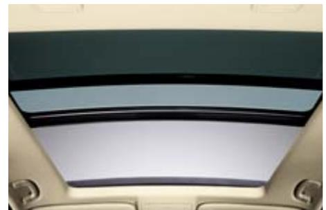
□ **Panorama Glasdach** mit großzügigem Öffnungs- und Durchsichtsbereich sowie geschwindigkeitsabhängigem Windabweiser. Beide Glashälften lassen sich per Tippfunktion elektrisch anheben, der vordere Teil verfügt zusätzlich über Schiebefunktion, elektrischen Schwebehimmel (Sonnenschutz) sowie Komfortöffnung/-schließung mit Einklemmschutz.
