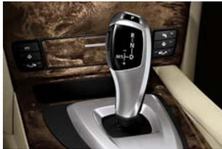
□ **6-Gang Automatic-Getriebe** mit Steptronic. Die Schaltung ermöglicht sehr schnelle und absolut fehlerfreie Gangwechsel – für ein Höchstmaß an Fahrdynamik (Serie für 535d, für 520d mit anderer Wählhebel-Optik ausgeführt).
