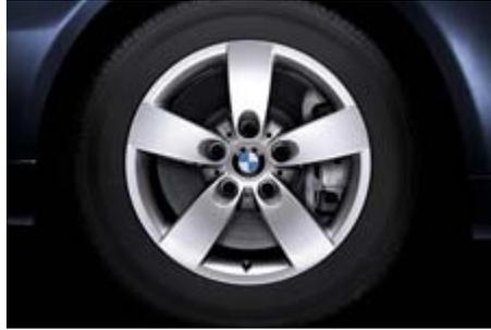
■ **BMW Leichtmetallräder Sternspeiche 242,** 7 J x 16 Zoll, Bereifung 225/55 R 16 (inkl. Radsicherungsschrauben; Serie für 523i, 525i, 520d und 525d).
