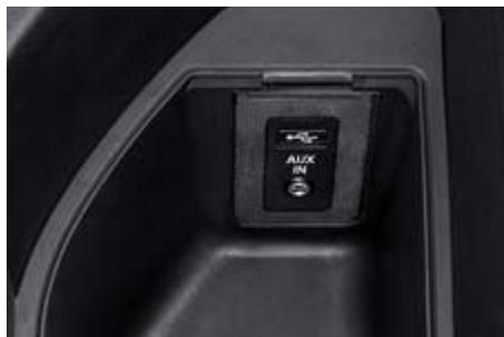
□ **USB-Audio-Schnittstelle** im Ablagefach unter der Armauflage vorn. Ermöglicht den Anschluss eines USB-Sticks und externer Audioquellen, wie z.B. eines MP3-Players.
