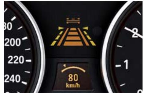
□ **Spurverlassenswarnung** erkennt mithilfe einer Kamera bereits das Annähern an eine Fahrbahnmarkierung und warnt den Fahrer sofort per Vibration im Lenkrad. Das System ist für Bundesstraßen und Autobahnen ausgelegt und wird über eine Taste im Multifunktionslenkrad ein- und ausgeschaltet.
