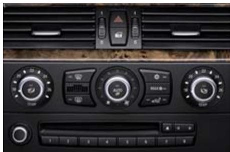
□ **Klimaautomatik mit erweitertem Umfang**, inkl. Automatischer Umluft Control (AUC), Solar- und Beschlagsensor, autom. Temperaturregelung und Luftverteilung (getrennt für Fahrer und Beifahrer) sowie Luftmengenregelung; Anzeige und Einstellungen über das Control Display. Ausstattung umfasst auch die verschiebbare Armauflage mit klimatisiertem Ablagefach (Serie für 540i, 550i und 535d).
