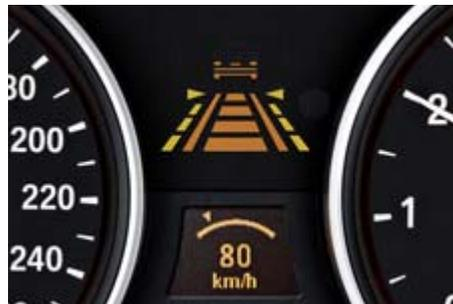
□ **Spurverlassenswarnung** erkennt mithilfe einer Kamera bereits das Annähern an eine Fahrbahnmarkierung und warnt den Fahrer sofort per Vibration im Lenkrad. Das System ist für Bundesstraßen und Autobahnen ausgelegt und wird über eine Taste im Multifunktionslenkrad ein- und ausgeschaltet.
