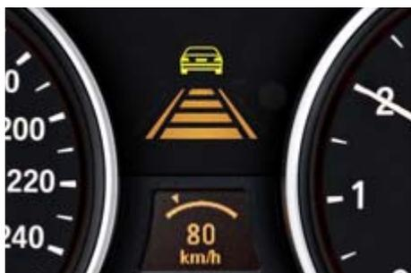
□ **Aktive Geschwindigkeitsregelung mit Stop&Go-Funktion** ermöglicht das komfortable Fahren mit einer vorgewählten Geschwindigkeit (30–180 km/h). Bei Kolonnenfahrt passt sich Ihr BMW an ein langsamer vorausfahrendes Fahrzeug an und hält automatisch einen vorgewählten Abstand ein.
