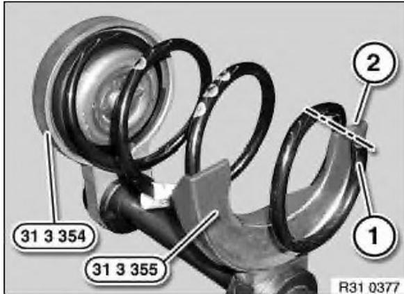
Schraubenfeder mit Federteller in das Spezialwerkzeug 31 3 355 und 31 3 354 einsetzen.
