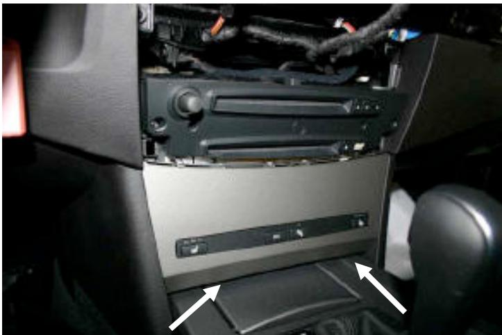
Nächster Schritt: entfernen Sie bitte nun die untere Plastik Blende, diese ist nur gesteckt. Danach lösen Sie bitte die vier Schrauben von dem DVD Navi Rechner und ziehen diesen dann komplett raus.
