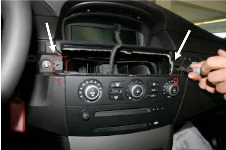
Als nächstes bitte die Blende mit dem Bedienteil für Klimatronic rausziehen und nach oben Klappen. Sie können die Stecker von dem Bedienteil rausziehen, das erleichtert ein wenig. ACHTUNG: die Blende ist oben mit zwei Schrauben befestigt, unten ist diese nur gesteckt, vorsichtig rausziehen.
